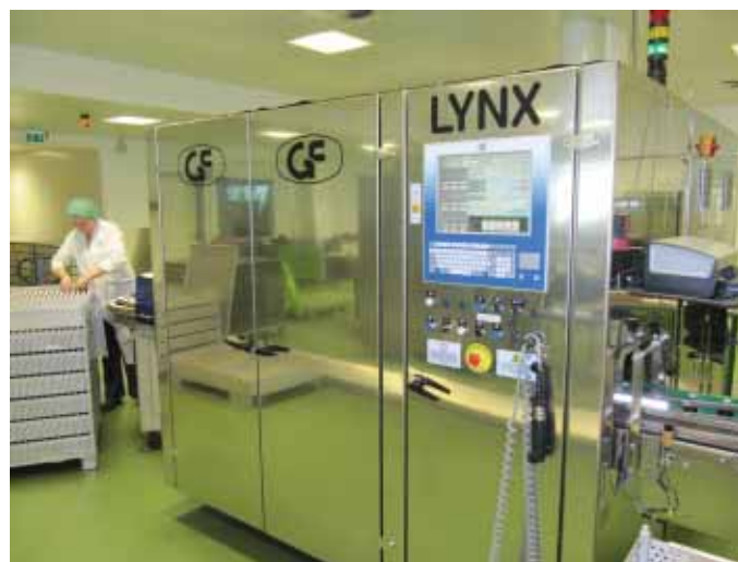
Инспекционная машина для флаконов GF, Италия, на заводе Solupharm, Германия
