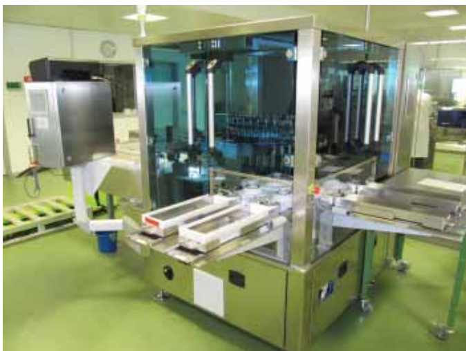
Инспекционная машина Brevetti ATM-32 на заводе Solupharm, Германия
