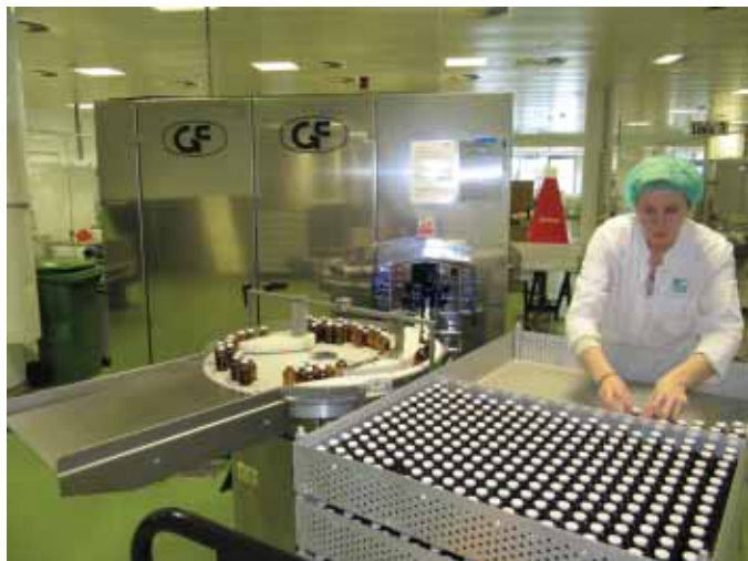
Инспекционная машина для флаконов GF, Италия, на заводе Solupharm, Германия
