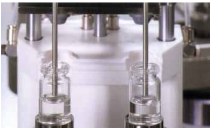
рис. 2 Встроенные весы, совмещённые со станцией наполнения
