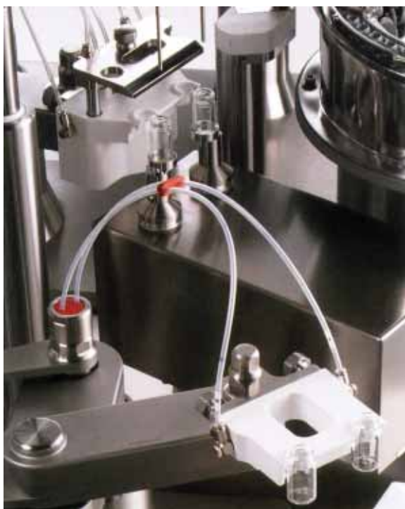
рис. 5 Станции наполнения, контроля процесса и предукупорки
