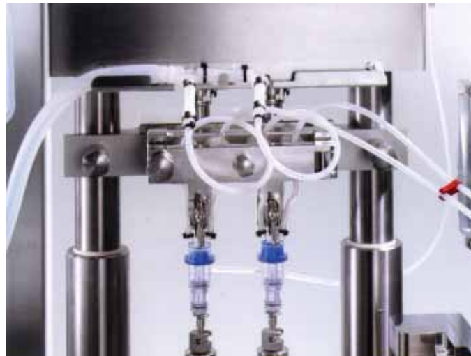
рис. 3 Комбинированная станция наполнения с ролико-мембранным насосом
