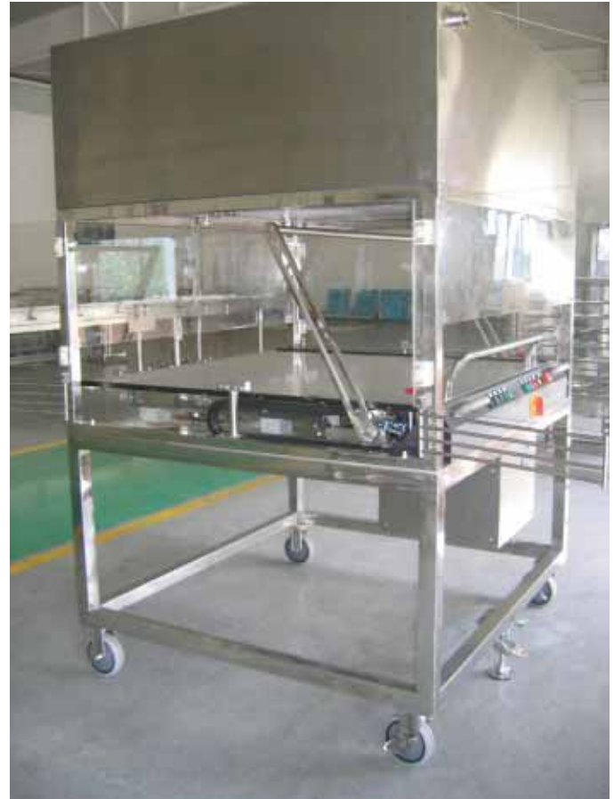
Рис.8 Транспортная тележка с ламинарным потоком для полуавтоматической системы загрузки и разгрузки
