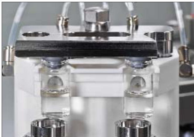
Укупорка пробкой непосредственно после розлива
