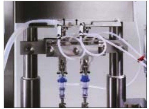
Комбинированная станция розлива с одноразовыми ролик-мембранными насос-дозаторами
