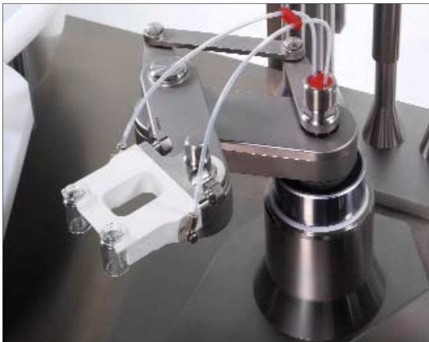
Транспортировка флаконов без контранправляющих с помощью разработанной Bosch системы Pharma Handling Unit
