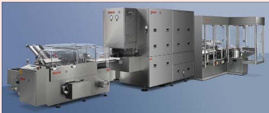
Комби-линия Bosch RRU-HQL-ALF Kombi для мойки – стерилизации – розлива – запайки / укупорки ампул и флаконов
