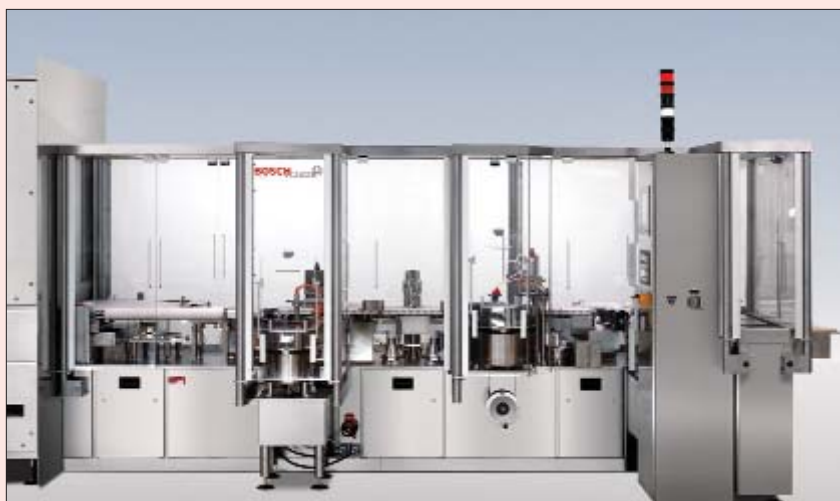
Комби-машина MLD для розлива и укупорки готовых шприцев и картриджей
