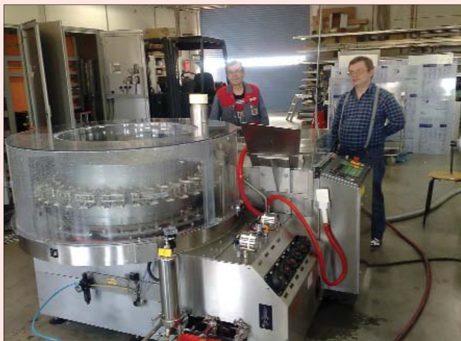
Ультразвуковая машина мойки ампул Bosch RRU 3040, прошедшая полную сервисно-техническую подготовку в Германии перед отправкой заказчику ФГУП «НПО «Микроген» МЗ РФ
