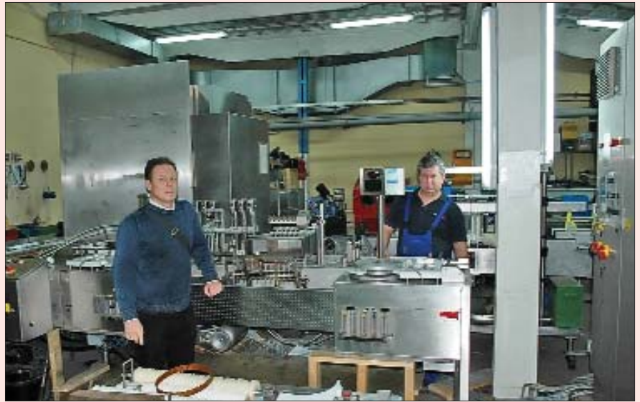
В мастерской компании ООО «Холдинг «Фарм Тех» в Москве. Сервис ампульной линии Bosch производительностью 18.000 амп/час. Линия находится в свободной продаже
