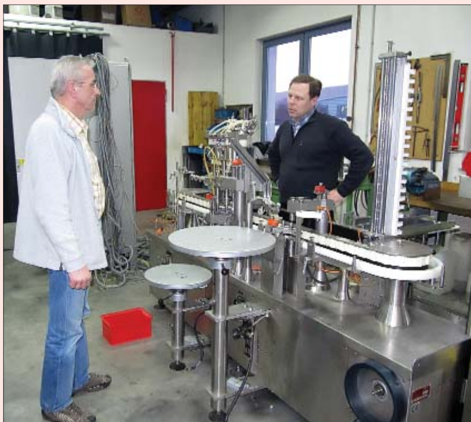
На фирме Heisswolf GmbH в Германии – основного партнера компании ООО «Холдинг «Фарм Тех». Обсуждение переделок на машине Bosch MLF 3002 (розлив, предукупорка/укупорка, закатка флаконов, 7.200 фл./час)
