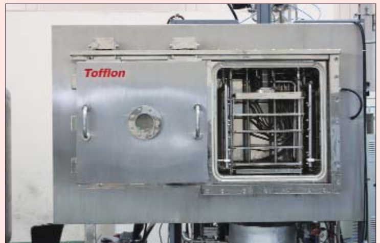
Рис. 20. Леофильная установка LYO-0,5 (SIP/CIP) в изоляторном исполнении* (специальная скользящая дверь), заказчик – РОНЦ им. Блохина
