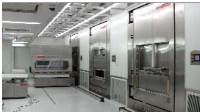
Рис. 15, 16. Гибкая автоматическая система загрузки и разгрузки продукта, обслуживающая несколько установок LYO-22 (SIP/CIP) – фото сделано на заводе заказчика
