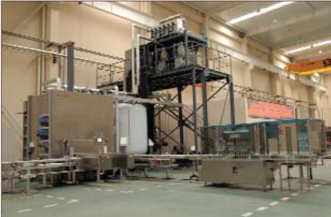
Рис. 17. Фиксированная автоматическая система загрузки и разгрузки ROW by ROW («Ряд-за-Рядом») для установки лифильной сушки LYO-25 (SIP/CIP)
