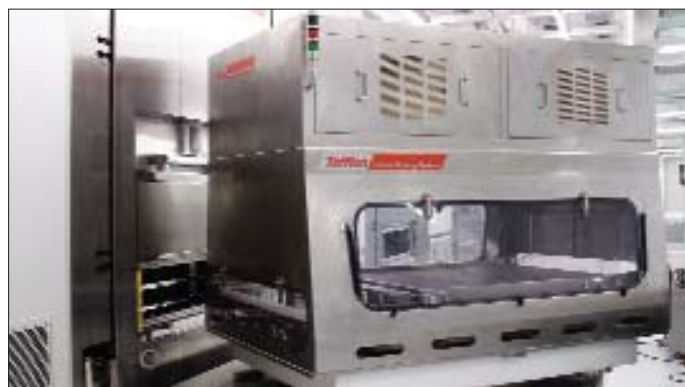
Рис. 15, 16. Гибкая автоматическая система загрузки и разгрузки продукта, обслуживающая несколько установок LYO-22 (SIP/CIP) – фото сделано на заводе заказчика
