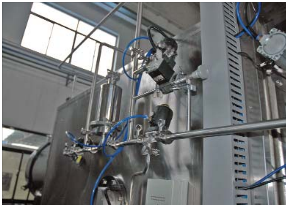
Рис. 23, 24. В настоящее время на заводе Tofflon для ОАО «Фармстандарт-УфаВита» изготавливается лиофильная установка LYO-10 (SIP/CIP) с тремя отдельными рамами и вертикальным конденсатором
