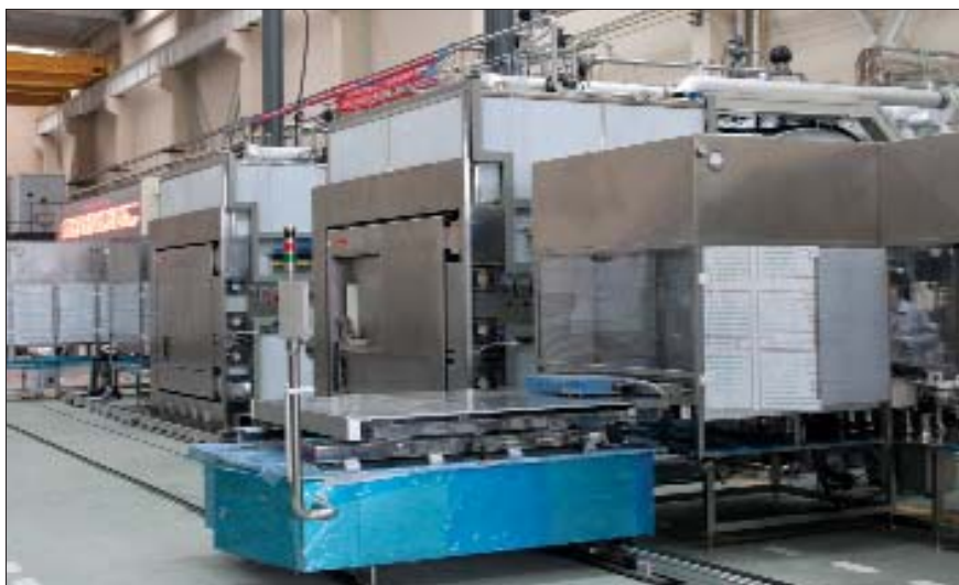
Рис. 1. Две установки LYO-15 (SIP/CIP) с вертикальной загрузочной дверцей и гибкой автоматической системой загрузки и разгрузки
