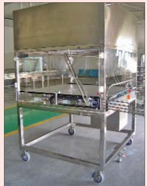
Рис. 13. Транспортная тележка с ламинарным потоком для полуавтоматической системы загрузки и разгрузки
