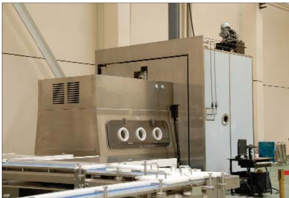
Рис. 14. Леофильная установка с изолятором производства Tofflon
