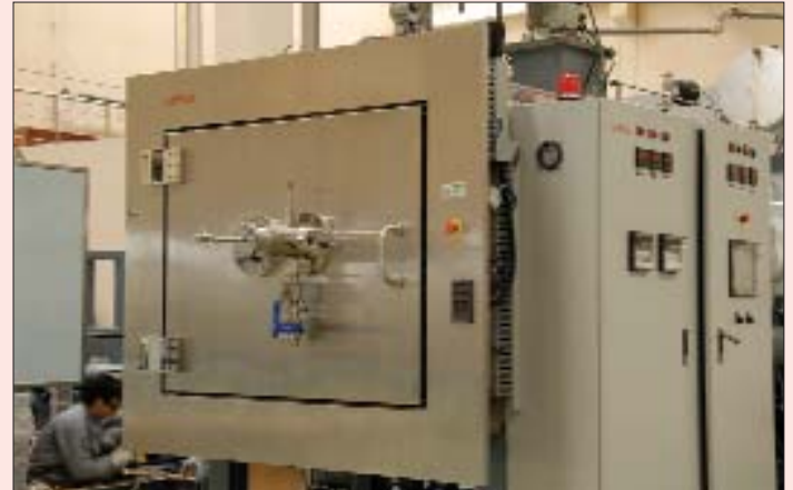
Рис. 18. Одна из трех лиофильных установок LYO-5 (SIP/CIP), изготовленных для ОАО «Фармстандарт» для проекта «Генериум»
